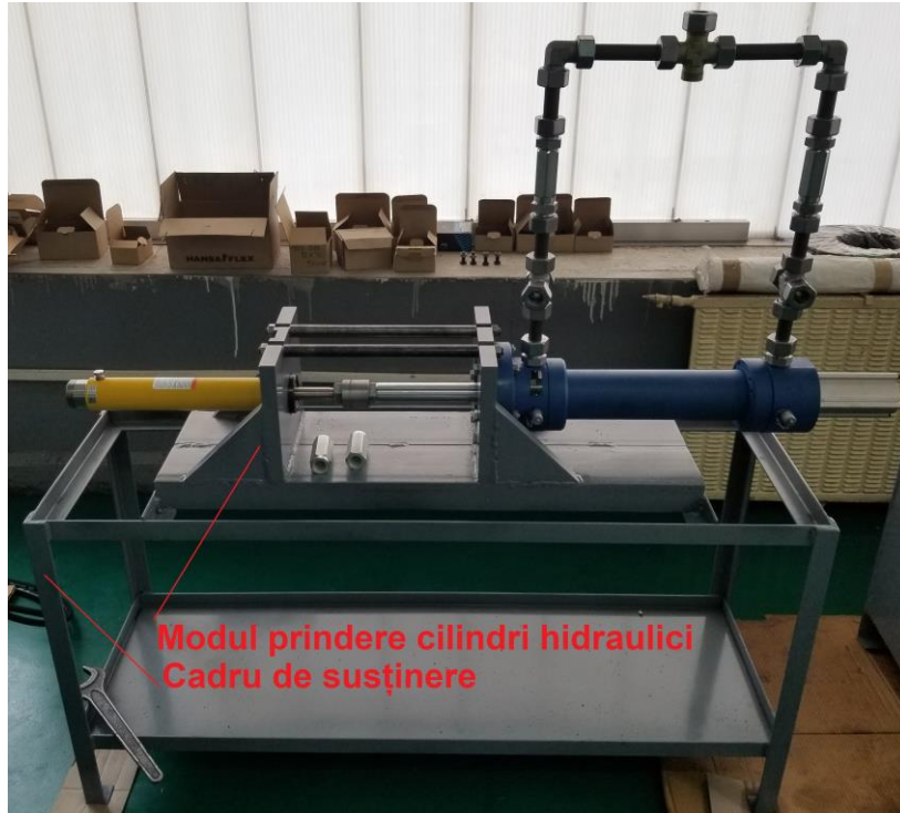
Fig.1: Modul de prindere și cadru de susținere cilindri hidraulici (execuție parțială).
