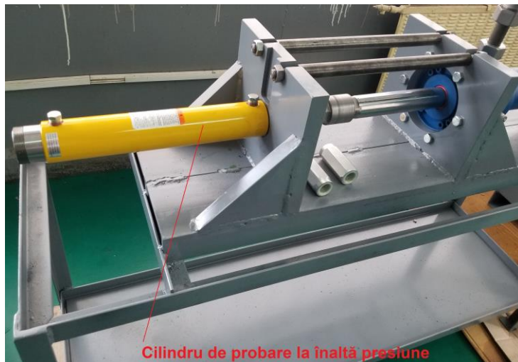
Fig.2: Montarea cilindrilor pe modulul de prindere.
