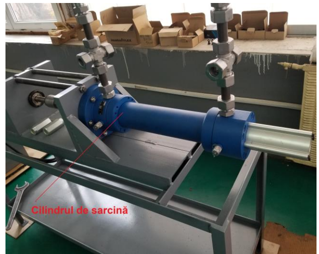
Fig.2: Montarea cilindrilor pe modulul de prindere.
