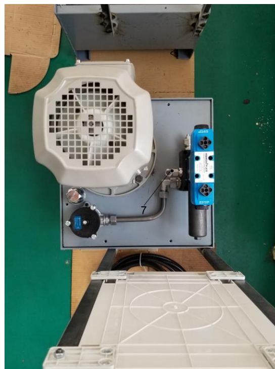
Fig.4: Modul pompare 3 kW-Vedere de sus.
