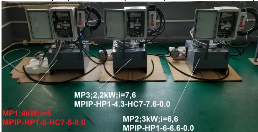
Modulele de pompare executate și montate (tablouri electrice deschise).
