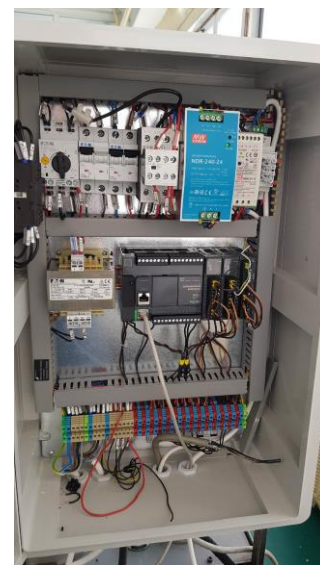
Fig.1: Tablou electric și de achiziție date (execuție finală).
