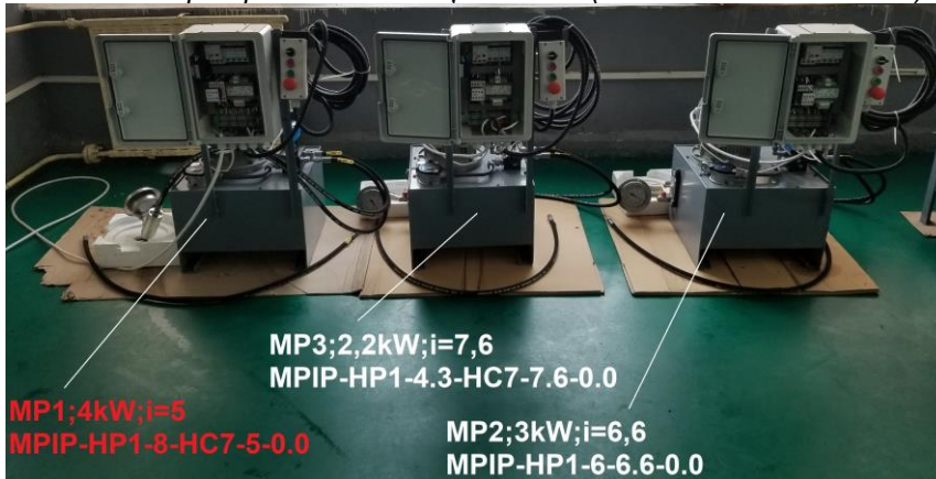
MP1; 4 kW; i=5 MPIP-HP1-8-HC7-5-0.0 MP3; 2,2 kW; i=7,6 MPIP-HP1-4.3-HC7-7.6-0.0 MP2; 3 kW; i=6,6 MPIP-HP1-6-HC7-6.6-0.0
