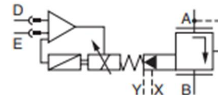
4.4 Supapă de presiune proporțională Bosch-Rexroth cod DBEB E10Z-1X/315 XYG24K31A1M
