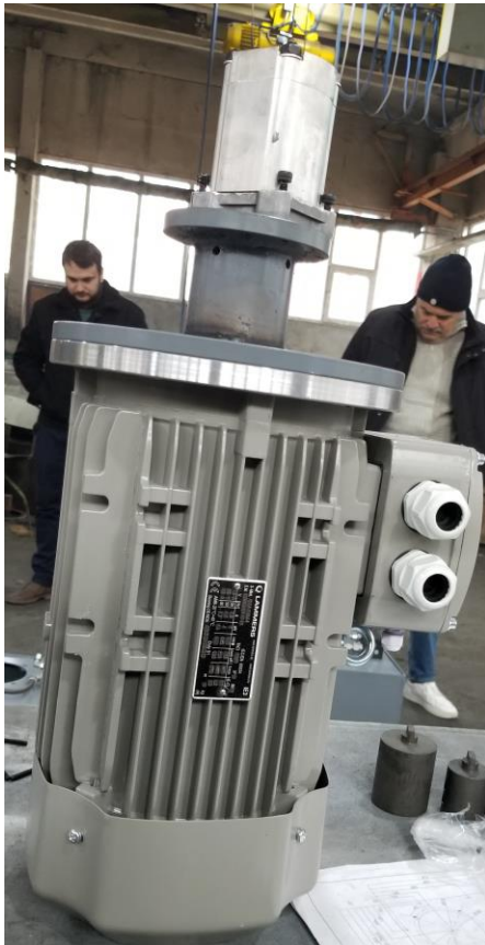
Fig.4: Detaliu de prindere a suportilor de electropompe pe flanșele motoarelor electrice
