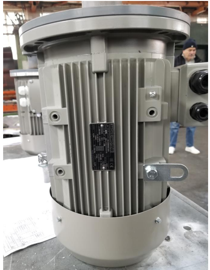
Fig.4: Detaliu de prindere a suportilor de electropompe pe flanșele motoarelor electrice
