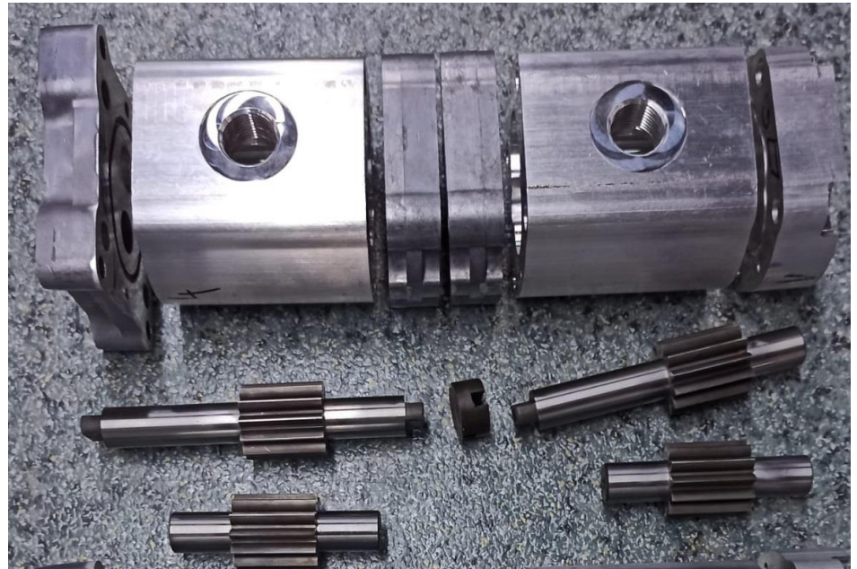
Fig.7: Execuția pompei simple (stânga) și pompei duble (dreapta) pentru electropompele de 4 kW și 9 kW
