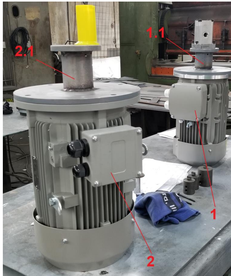
Fig.3: Pregătirea motoarelor electrice pentru electropompele de 4 kW și 9 kW
