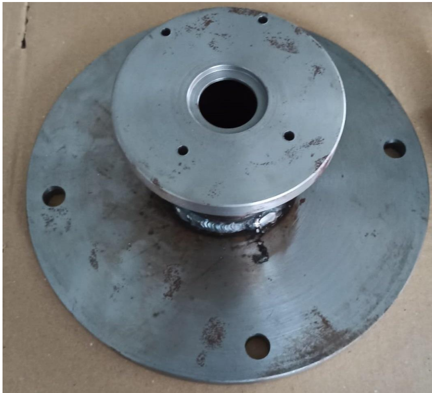
Fig.6: Execuția suportilor pentru electropompele de 4 kW și 9 kW
