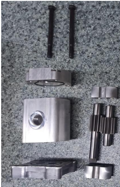
Fig.7: Execuția pompei simple (stânga) și pompei duble (dreapta) pentru electropompele de 4 kW și 9 kW
